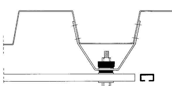
Антивибрационен монтаж на MPC монтажна шина към широка трапецовидна гофрирана ламарина чрез окачвач за въздушоводи.
